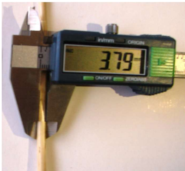
Foto 3. Determinarea diametrului cu șublerul electronic
